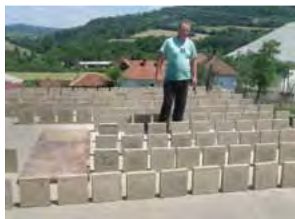
Сл. 8 – Сушење тугли Fig. 8 – Brick drying
