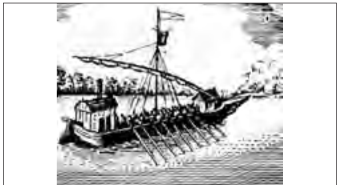
Slika 2 - Dunavska šajka - drveni ratni brod na vesla u upotrebi na Dunavu od XI do XVIII veka. Imala je oko 30 veslača i bila opremljena ostrim gvozdenim kljunom i naoružana topom od 40 funti i bočnim teškim mušketama. Značajne su bile dunavske srpske šajkaške flotile za odbranu od Turaka, a ratne baze bile su u Beogradu, Slankamenu, Petrovaradinu, Zemunu i Šapcu.
